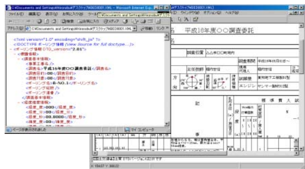
図 - 2 XML による柱状図の記述とその図化イメージ
